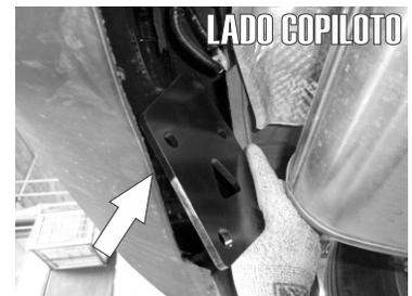
2.- Identifique por debajo del chasis por detrás de la defensa los tornillos que sujetan el soporte metálico y proceda a retirarlos.
