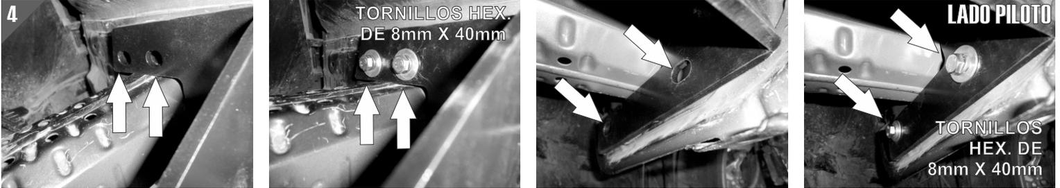
4.- Fije el Herraje Principal "A" a los barrenos roscados del chasis usando los tornillos de 8mm X 40mm con sus respectivas tuercas y rondanas de 5/16".
