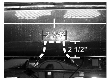
6.- Una vez puestos los tornillos tanto del lado piloto como copiloto deberá hacer un corte a la facia trasera para proceder a montar el Hitch. Mida en el centro de la defensa 2 3/4" de ancho por 2 1/2" de altura desde la base y corte la zona con una seguenta manual.
