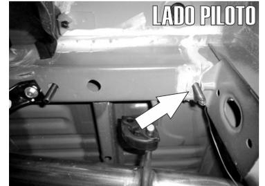
4.- De igual introduzca en el barreno posterior un Tornillo Especial de 3/8" junto con una solera con ayuda de la Guía de Micro-alambre introduciendolos desde el barreno de mayor diametro.
