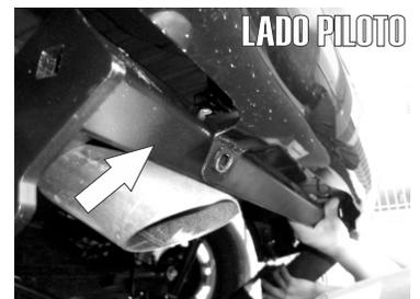
7.- Quite los tornillos laterales que sujetan la facia de la parte inferior de la carrocería para poder montar el Hitch pasandolo por encima del mofle y situandolo junto detras de la defensa como se muestra en las fotos.
