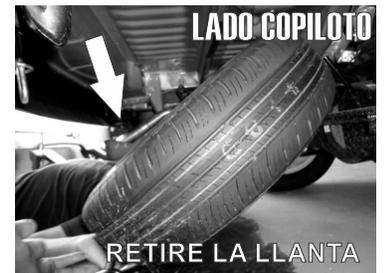
1.- Primeramente deberá retirar la llanta de refacción de la parte trasera del vehículo aflojando el tornillo que engancha a la misma tal como se muestra en las imágenes.
