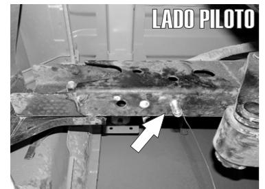
1.- Ubique los barrenos inferiores del chasis y con ayuda de la Guía de Micro-Alambre introduzca un Tornillo Cab. de Coche de 1/2" X 1 1/2" con una Solera cuadrada en el barreno posterior, tal como muestran las imágenes.
