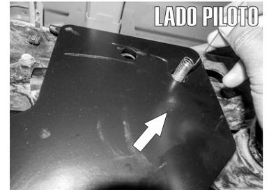
4.- Por la parte interna lateral del chasis, inserte en los barrenos alineados al tirón, una Guía de Micro-Alambre e introduzca un Tornillo Cab. de Coche de 1/2" X 1 1/2" con una Solera cuadrada en el barreno posterior.
