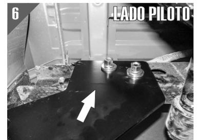
5.- De igual forma con ayuda de la Guía de Micro-Alambre introduzca otro Tornillo Cab. de Coche de 1/2" X 1 1/2" junto con una Solera cuadrada en el primer barreno, tal como se observa.
