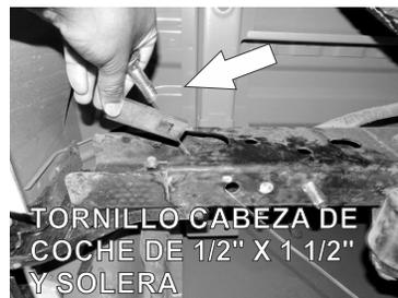
2.- De igual forma con ayuda de la Guía de Micro-Alambre introduzca otro Tornillo Cab. de Coche de 1/2" X 1 1/2" junto con una Solera cuadrada en el primer barreno, tal como se observa.
