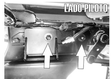
5.- Por último inserte nuevamente de manera manual un tornillo más de 1/2" X 1 1/2" y una solera rectangular de 3" X 1" en el segundo barreno lateral de chasis y termine de fijar los tornillos con las tuercas y rondanas de 1/2".
