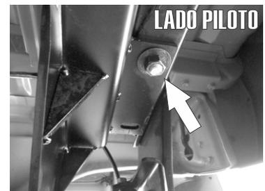
2.- Una vez puesto el tornillo presente el Hitch y alinee el barreno a este. Fijelo usando las tuercas y rondanas de 1/2".
