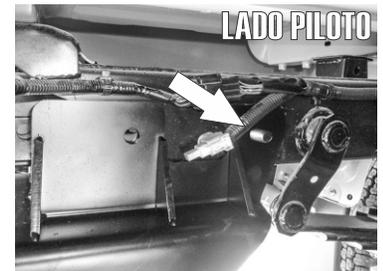
4.- Por la parte lateral interna del Chasis inserte otro tornillo cab. coche de 1/2" X 1 1/2" y una solera rectangular de 3" X 1" ayudandose de la guía de micro-alambre igual que en el paso uno.
