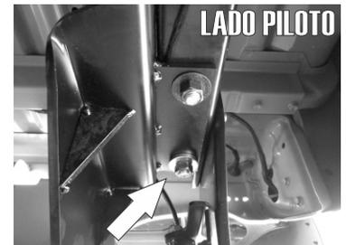
3.- Ahora inserte otro tornillo cab. coche de 1/2" X 1 1/2" y una solera rectangular de 3" X 1" en el segundo barreno al final del chasis y fijelo igualmente con las tuercas y rondanas de 1/2".
