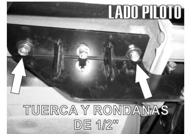
13.- Con mucho cuidado presente el Hitch e insertelo por debajo de la defensa trasera del vehículo en posición con respecto a insertados y fijelo a estos usando la tuerca y rondanas de 7/16" para el tornillo intermedio y las tuercas y rondanas de 1/2" para los tornillos en los extremos.
