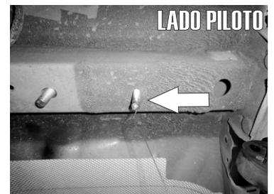
6.- De igual manera, pero con un tornillo especial de 7/16" X 1 1/2", insertelo en el barreno medio del chasis, indicado dejando igualmente la rosca hacia abajo.
