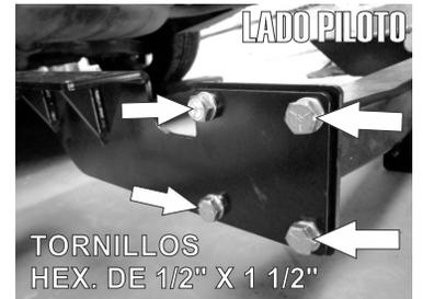
12.- Ahora deberá armar el Hitch Bronx montando los herrajes al cuerpo usando cuatro tornillos por cada lado de 1/2" X 1 1/4" con las rondanas de presión de 1/2".
