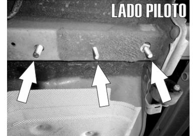
11.- Inserte un tornillo cab. de coche de 1/2" más junto con una solera cuadrada en el primer barreno ayudándose de la guía de micro-alambre y deje la rosca hacia abajo como los anteriores.
