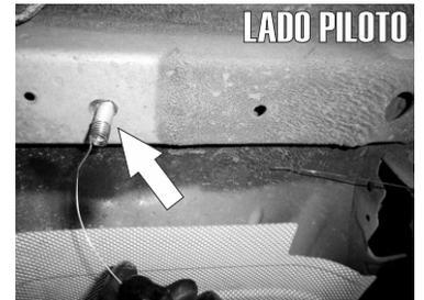
5.- Una vez ya despejada el área, en la parte lateral del chasis posterior al vehículo, inserte un tornillo cab. de coche de 1/2" X 1 1/2" junto con la solera cuadrada al barreno posterior indicado en las imágenes, ayudándose de la guía de micro-alambre dejando la rosca hacia abajo tal como se observa.
