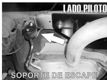
14.- Una vez ya fijado y apretado el Hitch suba y sujete nuevamente el escape en su lugar montando los soportes retirados con anterioridad.
