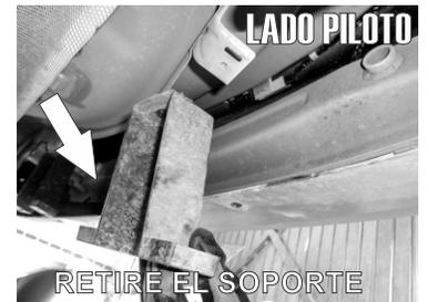
4.- También deberá retirar el soporte plástico sujeto al chasis retirando el tornillo y la grapa que lo sujeta a la parte metálica para retirarlo completamente.
