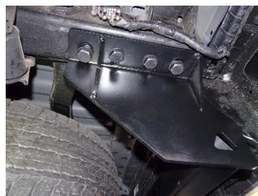
3.- Coloque los Tornillos Cab. Hex. 14x140 mm, Rondana plana y de Presión de 5/8". En los barrenos existentes como se muestra en las imágenes.
