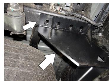
1.- Ubique los barrenos existentes que se encuentran sobre el brazo inferior del chasis.
