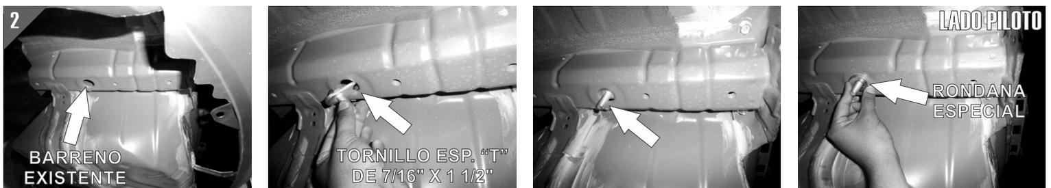
2.- Ahora identifique el barreno señalado en la parte inferior del chasis e introduzca un Tornillo Esp. "T" de 7/16" X 1 1/2" dejando la rosca hacia abajo tal como se ilustra poniendo una rondana especial a modo de calza.
