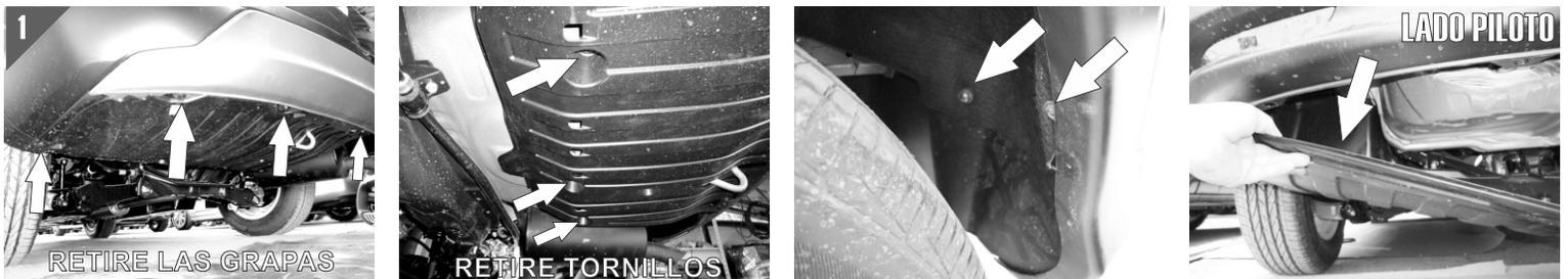
1.- Identifique la facia por debajo del Vehículo y proceda a retirarla quitando las grapas inferiores, los tornillos de los salpicaderos y las tuercas centrales que la fijan para continuar con la instalación de los herrajes.
