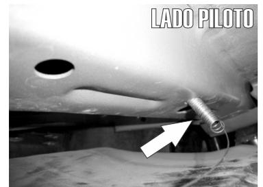
3.- Una vez descubierto por encima del escape identifique los barrenos en el chasis e inserte un tornillo especial "T" con ayuda de la guía de micro alambre pasando del barreno de mayor diámetro al segundo barreno señalado en las imágenes dejando la rosca hacia abajo.
