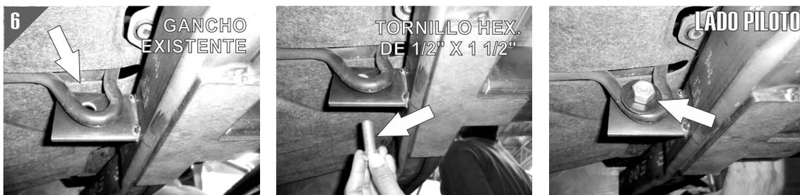
6.- Por la parte media posterior del Hitch fijelo al gancho existente usando un tornillo hex. de 1/2" X 1 1/2" usando dos rondanas Cal. 3/16" por ambos lados.
