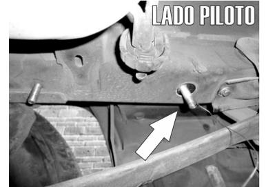
2.- Ahora en el mismo barreno deberá fijar un tornillo cab. de coche de 1/2" X 1 1/2" junto con una solera cuadrada de 3" X 1" y ayuda de la guía a modo de dejar el tornillo igualmente con la rosca hacia abajo como se muestra.
