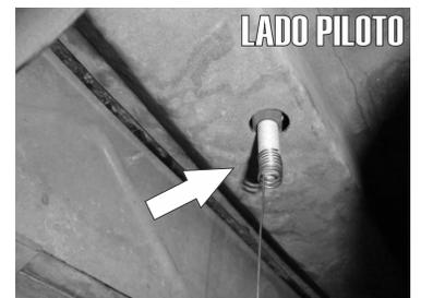
7.- En la parte posterior de la defensa, ubique los barrenos existente señalados en las fotos e inserte con ayuda de la guía un tornillo con varilla de 7/16" X 1 1/2" junto con una solera de 1.5mm X 2 1/4" dejando la rosca hacia abajo.
