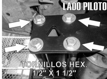
**8.-** Presente el Hitch Bronx y fijelo a los Herrajes instalados usando cuatro tornillos de 1/2" X 1 1/2" en cada lado.
