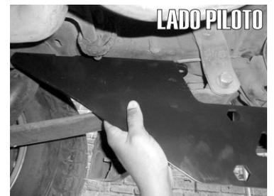
3.- Retire el tornillo existente aledaño usando el dado de 13mm.
