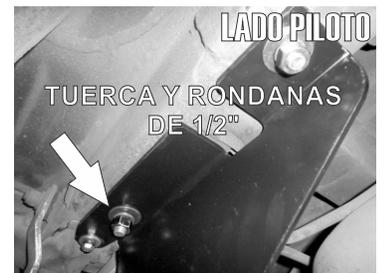
5.- Una vez puesto el Herraje fijelo al chasis usando un tornillo de 8mm X 30mm en el barreno desocupado con anterioridad.
