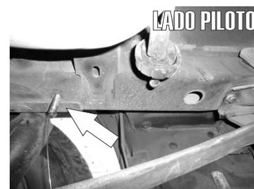
1.- Identifique por debajo del chasis de la parte trasera del vehículo los barrenos señalados en las imágenes y proceda a introducir un tornillo esp. "T" de 7/16" X 1 1/2" ayudandose de una guía micro-alambre, desde el barreno de mayor diámetro al posterior señalado. Deje la rosca del tornillo hacia abajo como se observa.
