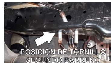
15.- Una vez que sea visible la Guía, repita el mismo procedimiento colocando el Tornillo Cab. Choche de 1/2" x 1 1/2", sobre el barreno de la Solera y enrosquelo a la guía, como se muestra en las imágenes. repita el mismo procedimiento para colocar el segundo tornillo en el barreno siguiente.
