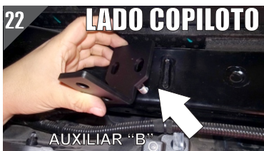
22.- Ya colocando ambos Tornillos con Varilla, proceda a montar los Herraje Auxiliar "B". (recuerde que se colocan dos auxiliares), y finalice colocando su Rondana Plana, de Presión y Tuerca Hexagonal de 7/16"
