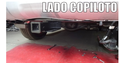
24.- Posicione el Tirón y haga coincidir los barrenos de este mismo con los barrenos de los Herrajes Principales "A", y a su vez coloque los Tornillos Cab.Hex de 1/2" x 1 1/2", Rondana Plana y de Presión de 1/2". Nota ; Realice el mismo procedimiento en el lado piloto ó copiloto ( dependiendo como haya comenzando a instalar).
