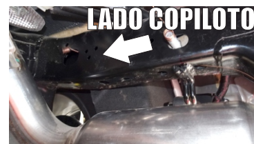
12.- Introduzca la Guía Micro-Alambre de 1/2" por el interior de la base Chasis Piloto/Copiloto, hasta hacerlo llegar al barreno existente que esta señalado en la imagen.
