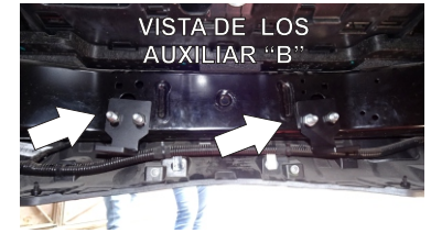
22.- Ya colocando ambos Tornillos con Varilla, proceda a montar los Herraje Auxiliar "B". (recuerde que se colocan dos auxiliares), y finalice colocando su Rondana Plana, de Presión y Tuerca Hexagonal de 7/16"
