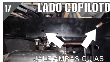
16.- Vaya posicionando el Herraje Principal, primero haga coincidir los Tornillos que se ubican en la parte baja y finalice colocando la Rondana Plana, de Presión y Tuerca Hexagonal de 1/2".
