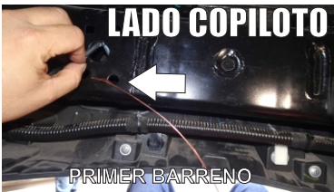
21.- Ahora que la guía ha salido del barreno existente grande, proceda a enroscar el Torn.Cab.Hex.Esp.c/Varilla de 7/16 " x 1 1/2 " , repita el mismo procedimiento para colocar el segundo tornillo con varilla. Nota repita este mismo proceso para poder colocar el segundo Auxiliar.
