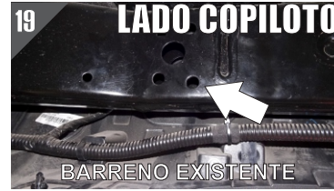
19.- Ubique los barrenos existentes que se encuentran en la defensa trasera por debajo del vehículo.
