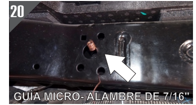
20.- Inserte la Guía por el barreno existente pequeño y dirija hacia el barreno existente grande como se observa en la imagen.
