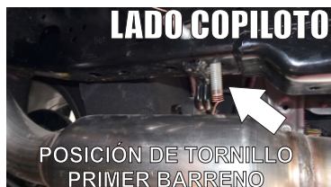
15.- Una vez que sea visible la Guía, repita el mismo procedimiento colocando el Tornillo Cab. Choche de 1/2" x 1 1/2", sobre el barreno de la Solera y enrosquelo a la guía, como se muestra en las imágenes. repita el mismo procedimiento para colocar el segundo tornillo en el barreno siguiente.
