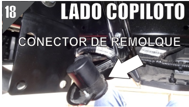
18.- Ubique el conector de remolque y retírelo de su base. utilice un dado de 10 mm.
