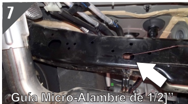
7.- Introduzca la Guía sobre el Barreno Existente.
