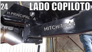
24.- Posicione el Tirón y haga coincidir los barrenos de este mismo con los barrenos de los Herrajes Principales "A", y a su vez coloque los Tornillos Cab.Hex de 1/2" x 1 1/2", Rondana Plana y de Presión de 1/2". Nota ; Realice el mismo procedimiento en el lado piloto ó copiloto ( dependiendo como haya comenzando a instalar).
