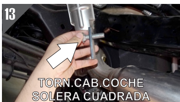
15.- Una vez que sea visible la Guía, repita el mismo procedimiento colocando el Tornillo Cab. Choche de 1/2" x 1 1/2", sobre el barreno de la Solera y enrosquelo a la guía, como se muestra en las imágenes. repita el mismo procedimiento para colocar el segundo tornillo en el barreno siguiente.
