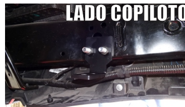
22.- Ya colocando ambos Tornillos con Varilla, proceda a montar los Herraje Auxiliar "B". (recuerde que se colocan dos auxiliares), y finalice colocando su Rondana Plana, de Presión y Tuerca Hexagonal de 7/16"
