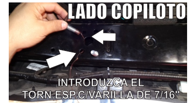
21.- Ahora que la guía ha salido del barreno existente grande, proceda a enroscar el Torn.Cab.Hex.Esp.c/Varilla de 7/16 " x 1 1/2 " , repita el mismo procedimiento para colocar el segundo tornillo con varilla. Nota repita este mismo proceso para poder colocar el segundo Auxiliar.
