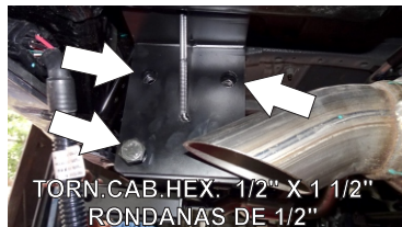
24.- Posicione el Tirón y haga coincidir los barrenos de este mismo con los barrenos de los Herrajes Principales "A", y a su vez coloque los Tornillos Cab.Hex de 1/2" x 1 1/2", Rondana Plana y de Presión de 1/2". Nota ; Realice el mismo procedimiento en el lado piloto ó copiloto ( dependiendo como haya comenzando a instalar).
