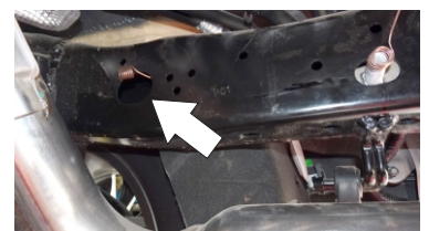
12.- Introduzca la Guía Micro-Alambre de 1/2" por el interior de la base Chasis Piloto/Copiloto, hasta hacerlo llegar al barreno existente que esta señalado en la imagen.
