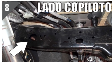
8.- Llegue la Guía al Barreno Existente que se observa en la imagen.
