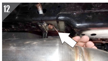
12.- Introduzca la Guía Micro-Alambre de 1/2" por el interior de la base Chasis Piloto/Copiloto, hasta hacerlo llegar al barreno existente que esta señalado en la imagen.
