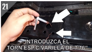
21.- Ahora que la guía ha salido del barreno existente grande, proceda a enroscar el Torn.Cab.Hex.Esp.c/Varilla de 7/16 " x 1 1/2 " , repita el mismo procedimiento para colocar el segundo tornillo con varilla. Nota repita este mismo proceso para poder colocar el segundo Auxiliar.
