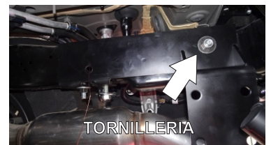
14.- Ya colocado la Tornillería en ambos brazos del chasis (Piloto/Copiloto), proceda a presentar y colocar los Herrajes Principales "A".
