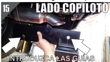
15.- Las Guías que recomendamos dejar al inicio, es para que las introduzca sobre los barrenos del Herraje Principal "A" y sea mas fácil sujetar.
