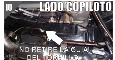
10.- Jale la Guía hasta posicionarla en el Barreno Existente que esta señalado. Nota: No retire la Guía del Tornillo.
