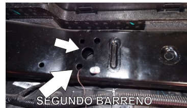
21.- Ahora que la guía ha salido del barreno existente grande, proceda a enroscar el Torn.Cab.Hex.Esp.c/Varilla de 7/16 " x 1 1/2 " , repita el mismo procedimiento para colocar el segundo tornillo con varilla. Nota repita este mismo proceso para poder colocar el segundo Auxiliar.
