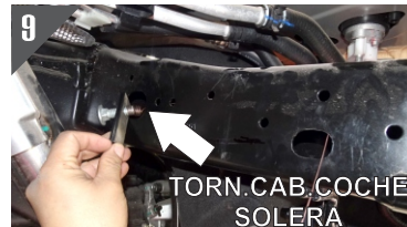
9.- Enrosque el Tornillo Cab. Choche de 1/2" x 1 1/2", pero antes introduzca la rosca en el barreno de la Solera Cuadrada.
