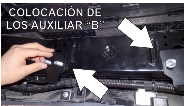
22.- Ya colocando ambos Tornillos con Varilla, proceda a montar los Herraje Auxiliar "B". (recuerde que se colocan dos auxiliares), y finalice colocando su Rondana Plana, de Presión y Tuerca Hexagonal de 7/16"
