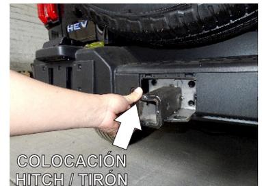
2.- Una vez retirada la tapa, puede observar varios barrenos existentes algunos con rosca, el cual le ayudara para poder fijar el Hitch / Tirón.
