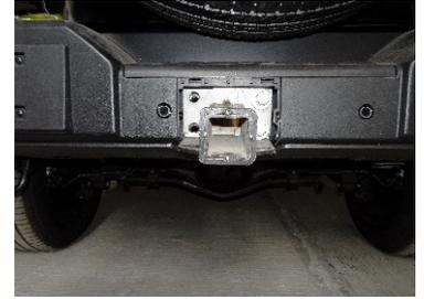
3.- Finalice colocando sobre los barrenos el Tornillo Cab.Hex. 14 X 40 mm, Rondana Plana y Rondana de Presión de 9/16".
