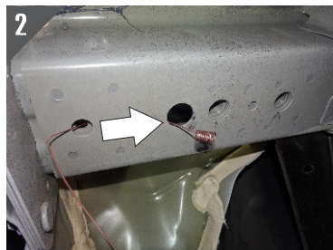
1.- Identifique los Barrenos Existentes que se encuentran en la parte inferior del Chasis de Lado Piloto.
