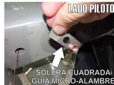
3.- Sujete la Solera Cuadrada e inserte sobre el barreno la Guía Micro-Alambre como se muestra en las imágenes.
