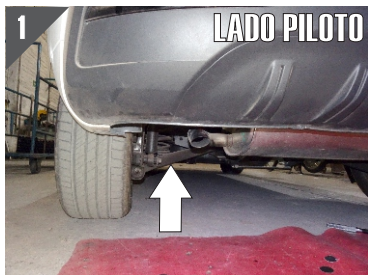
1.- Identifique los Barrenos Existentes que se encuentran en la parte inferior del Chasis de Lado Piloto.
