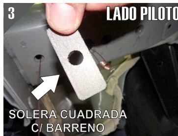
3.- Sujete la Solera Cuadrada e inserte sobre el barreno la Guía Micro-Alambre como se muestra en las imágenes.
