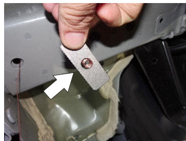
3.- Sujete la Solera Cuadrada e inserte sobre el barreno la Guía Micro-Alambre como se muestra en las imágenes.
