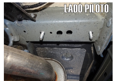
8.- Ahora nuevamente enrosque el Tornillo Cab. Hex. c/Varilla 7/16"X11/2", y comience a introducir primero la Solera en el barreno existente y enseguida el Tornillo y del otro extremo de la Guía Tire de el para que salga la rosca del tornillo.
