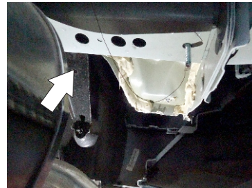
6.- Después de colocar la solera cuadrada dentro del barreno, introduzca ahora el Tornillo Esp.c/Varilla en el mismo barreno existente y jale la Guía hasta ver salir la rosca del Tornillo por el Primer barreno. Como se observa en las imágenes / repita la misma instalación en el lado Copiloto.
