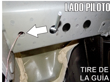
6.- Después de colocar la solera cuadrada dentro del barreno, introduzca ahora el Tornillo Esp.c/Varilla en el mismo barreno existente y jale la Guía hasta ver salir la rosca del Tornillo por el Primer barreno. Como se observa en las imágenes / repita la misma instalación en el lado Copiloto.
