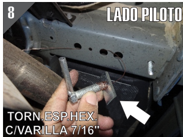
8.- Ahora nuevamente enrosque el Tornillo Cab. Hex. c/Varilla 7/16"X11/2", y comience a introducir primero la Solera en el barreno existente y enseguida el Tornillo y del otro extremo de la Guía Tire de el para que salga la rosca del tornillo.
