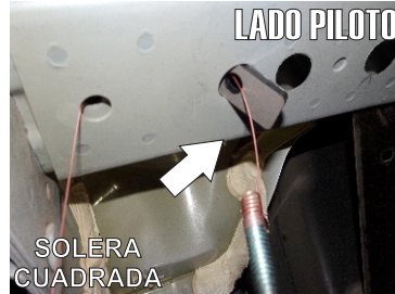
5.- Una vez enroscado el Tornillo Esp.c/Varilla 5/16"x1 1/2", comiencen a introducir la Solera Cuadrada c/Barreno en el barreno existente. como se muestra en las imágenes.
