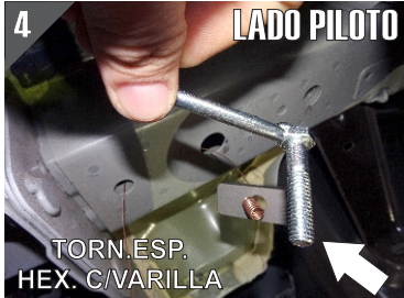
4.- Ahora enrosque el Tornillo Esp Hex. c/Varilla 5/16" x 1 1/2" en la Guía
