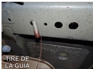
8.- Ahora nuevamente enrosque el Tornillo Cab. Hex. c/Varilla 7/16"X11/2", y comience a introducir primero la Solera en el barreno existente y enseguida el Tornillo y del otro extremo de la Guía Tire de el para que salga la rosca del tornillo.
