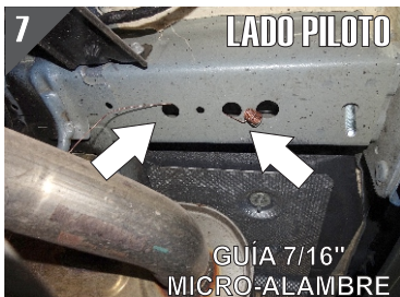
7.- Introduzca la Guía Micro-Alambre como se muestra en la imagen e inserte la guía sobre la Solera Desbastada de Punta.
