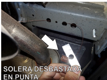
7.- Introduzca la Guía Micro-Alambre como se muestra en la imagen e inserte la guía sobre la Solera Desbastada de Punta.
