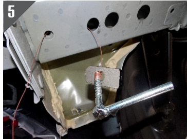
5.- Una vez enroscado el Tornillo Esp.c/Varilla 5/16"x1 1/2", comiencen a introducir la Solera Cuadrada c/Barreno en el barreno existente. como se muestra en las imágenes.
