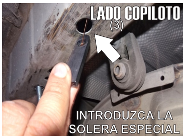
9.- Sobre el mismo Barreno Existente (3) introduce la Solera Especial y tire de la Guía hasta ver salir la rosca del Tornillo que coloco sobre el mismo barreno y a si tener los 3 barrenos existentes con sus respectivos Tornillos. Observe las imagenes para mejores referencias y aplique el mismo procedimiento en el Lado Piloto.
