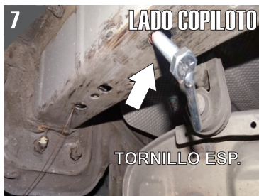
7.- Una vez que introduzco la Solera Esp., realizara el mismo procedimiento pero esta vez introduce el Tornillo Cab.Hex. Esp. de 3/8" X 1 1/2" y tire de la Guía hasta ver salir la rosca del Tornillo en el Barreno Existente (1).
