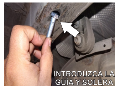
9.- Por último coloque de la siguiente manera. Ya que tiene insertado la solera y enroscado el Tornillo Esp. sobre la Guía. comenzara introduciendo el Tornillo Esp. sobre el Barreno Existente (3).
