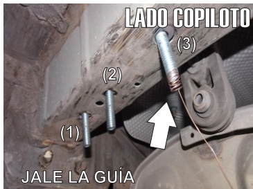
9.- Sobre el mismo Barreno Existente (3) introduce la Solera Especial y tire de la Guía hasta ver salir la rosca del Tornillo que coloco sobre el mismo barreno y a si tener los 3 barrenos existentes con sus respectivos Tornillos. Observe las imagenes para mejores referencias y aplique el mismo procedimiento en el Lado Piloto.
