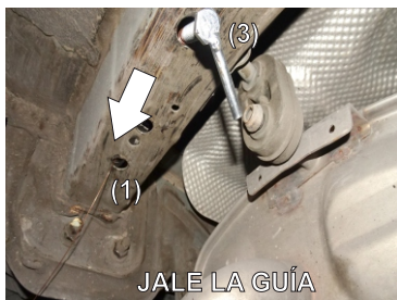
7.- Una vez que introduzco la Solera Esp., realizara el mismo procedimiento pero esta vez introduce el Tornillo Cab.Hex. Esp. de 3/8" X 1 1/2" y tire de la Guía hasta ver salir la rosca del Tornillo en el Barreno Existente (1).
