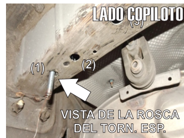
7.- Una vez que introduzco la Solera Esp., realizara el mismo procedimiento pero esta vez introduce el Tornillo Cab.Hex. Esp. de 3/8" X 1 1/2" y tire de la Guía hasta ver salir la rosca del Tornillo en el Barreno Existente (1).
