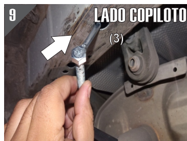
9.- Por último coloque de la siguiente manera. Ya que tiene insertado la solera y enroscado el Tornillo Esp. sobre la Guía. comenzara introduciendo el Tornillo Esp. sobre el Barreno Existente (3).
