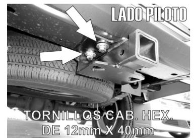
1.- Ubique los barrenos roscados que se encuentran en la parte inferior de la defensa trasera del Vehículo y presente el Hitch alineandolo y fijandolo con los Tornillos Cab, Hex. de 12mm X 40mm.
