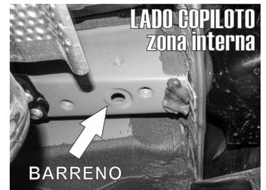
1.- Primeramente ubique el gancho existente en el lado copiloto del auto y proceda a retirarlo quitando los tornillos existentes que lo sujetan al chasis.
