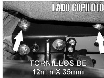
6.- Use los tornillos de 12mm X 35mm para fijar el Hitch a los barrenos roscados existentes al chasis, colocando dos inferiores y dos laterales tal como se observa en las fotos.
