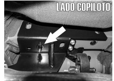
5.- presente el Hitch Bronx y fíjelo al tornillo previamente insertado en el barreno inferior, usando las rondanas y tuerca de 3/8".
