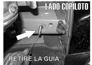
3.- Con ayuda de una Guía de Micro-alambre inserte un Tornillo Esp. con varilla soldada junto con una Solera, insertando primero el tornillo y posteriormente la solera para después sacar la rosca hacia abajo tal como se ilustra en las imágenes.
