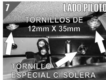
7.- Para el LADO PILOTO solo deberá poner el tornillo especial con la solera para la parte inferior y fijar la parte lateral con dos tornillos de 12mm X 35mm.
