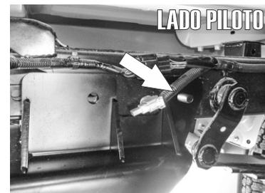
4.- Por la parte lateral interna del Chasis inserte otro tornillo cab. coche de 1/2" X 1 1/2" y una solera rectangular de 3" X 1" ayudandose de la guía de micro-alambre igual que en el paso uno.
