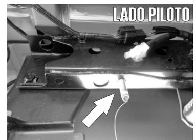
1.- Identifique por debajo del chasis de la parte trasera del vehículo el barreno señalado en la primer imagen e inserte un tornillo cab. coche de 1/2" X 1 1/2" y una solera rectangular de 3" X 1" ayudandose de la guía de micro-alambre dejando la rosca sobresaliente tal como se muestra.
