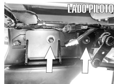
5.- Por último inserte nuevamente de manera manual un tornillo más de 1/2" X 1 1/2" y una solera rectangular de 3" X 1" en el segundo barreno lateral de chasis y termine de fijar los tornillos con las tuercas y rondanas de 1/2".
