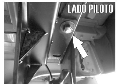
2.- Una vez puesto el tornillo presente el Hitch y alinee el barreno a este. Fíjelo usando las tuercas y rondanas de 1/2".
