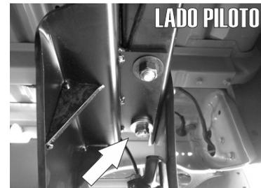
3.- Ahora inserte otro tornillo cab. coche de 1/2" X 1 1/2" y una solera rectangular de 3" X 1" en el segundo barreno al final del chasis y fijelo igualmente con las tuercas y rondanas de 1/2".
