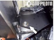
6.- Para reforzar el accesorio con la defensa, utilice un Tornillo Hex. de 1/2" X 1 1/2" junto con una solera cuadrada y paselo entre el orificio de ambas estructuras tal como se muestra.
