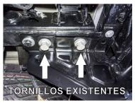
5.- Vuelva a colocar la defensa en su posición y fijela por debajo de Hitch usando los tornillos existentes retirados en el paso 3.
