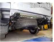
3.- Afloje el tornillo aledaño al perno retirado y retire completamente los dos tornillos que sujetan a la defensa con el chasis para poder quitar la defensa completamente.
