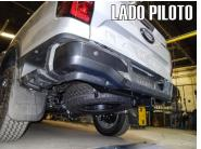
7.- Donde se retiró el perno plástico del paso 2 deberá insertar un Tornillo Hex. de 3/8" X 1 1/4" con doble rondana (arriba y abajo) para completar la fijación. Finalmente alinee y apriete todos los tornillos.
