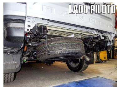
3.- Afloje el tornillo aledaño al perno retirado y retire completamente los dos tornillos que sujetan a la defensa con el chasis para poder quitar la defensa completamente.
