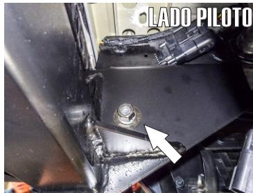
6.- Para reforzar el accesorio con la defensa, utilice un Tornillo Hex. de 1/2" X 1 1/2" junto con una solera cuadrada y paselo entre el orificio de ambas estructuras tal como se muestra.
