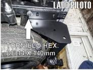
4.- Presente el Hitch en dirección a los barrenos de Tornillos retirados y fijelo al primer barreno existente usando un Tornillo Hex. de 14 X 140mm.
