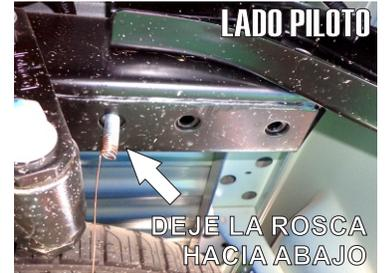
4.- Identifique los barrenos existentes por debajo del chasis y proceda a introducir en el primer barreno, de adelante hacia atrás, un Tornillo Esp "T" de 7/16" junto con una Rondana Plana de 7/16" Cal. 3/16" ayudandose de la guía de micro-alambre dejando la rosca hacia abajo tal como se muestra en las imágenes.
