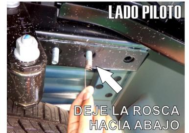
5.- Vuelva a introducir en el segundo barreno, de adelante hacia atrás, otro Tornillo Esp "T" de 7/16" junto con una Rondana Plana de 7/16" Cal. 3/16" ayudandose de la guía de micro-alambre dejando la rosca hacia abajo tal como se muestra en las imágenes.
