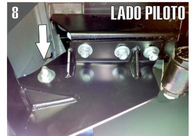
6.- Coloque manualmente un Tornillo más Esp "T" de 7/16" junto con una Rondana Plana de 7/16" Cal. 3/16" con la rosca hacia abajo.
