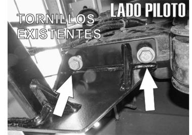
5.- Una vez retirados todos los tornillos que lo sujetan, deberá retirar el tirón existente, jalando junto con la defensa (Se sugiere descansar la sobre dos bases cerca del auto para no dañar el cableado) y finalmente retirando el tirón hacia abajo.
