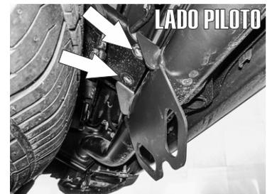
1.- Primeramente será necesario identificar el tirón ya existente para retirarlo. Ubique los conectores por detras de la defensa trasera y proceda a desenchufarlos.
