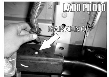
1.- Primeramente ubique los tornillos existentes que sujetan la defensa trasera del vehículo y proceda a retirarlos.
