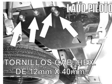
3.- Finalmente presente e instale el Hitch Bronx en los barrenos desocupados con anterioridad con los Tornillos Cab. Hex. de 12mm X 40mm con sus rondanas de 1/2".
