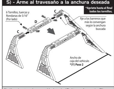
5) - Ahora inserte ambos ensambles laterales (C) al travesaño superior (D) e igualmente ajuste al ancho deseado conforme a la medida de la caja.
