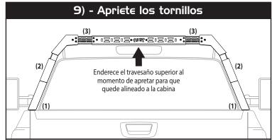
9) - Finalmente apriete todos los tornillos, empezando por los que fijan el Roll Bar a la batea de la caja (1), después los brazos a las bases laterales (2) y por último el travesaño y los ajustes superiores (3) procurando levantarlo manualmente para que quede alineado a la cabina.
