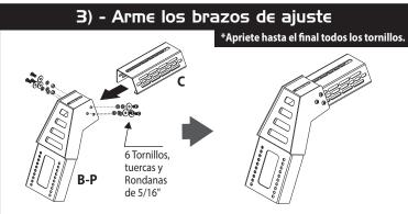
3) - Arme primeramente el brazos de ajuste (B-P y B-C) con las extensiones de ajuste supeiores (C). No apriete aun ningun tornillo hasta el final.
