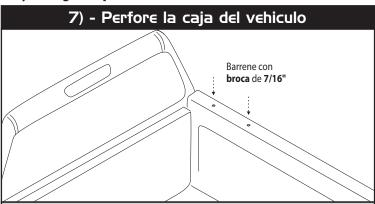
7) - Una vez que tenga los barrenos marcados proceda a barrenar el canto de la caja usando un taladro junto con la broca de 7/16" para tornillo de 3/8".
