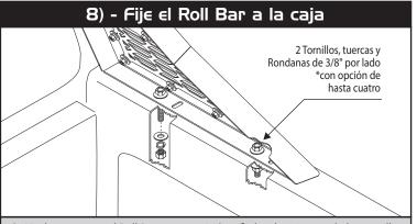
8) - Vuelva a montar el Roll Bar en su posición y fijelo a la caja usando los tornillos, tuercas y rondanas de 3/8". Recomendamos poner dos tornillos por lado pero puede fijar un tercer o cuarto tornillo si así lo requiere.
