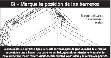
6) - Presente el Roll Bar por encima de la caja del vehiculo para marcar la posición de los barrenos a realizar.
