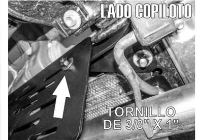
**13.-** Inserte el **Herraje Auxiliar** fijándolo con el tornillo insertado en el primer paso, usando la rondana plana y la tuerca de seguridad de 7/16". Termine de fijar el Herraje al protector de catalizador con un Tornillo de 3/8" X 1".
