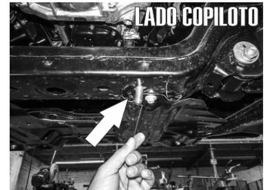
10.- Identifique del barreno existente por debajo del travesaño que se encuentra por debajo del motor, e introduzca, con ayuda de una guía de micro-alambre, un Tornillo Cab. de Coche de 1/2" X 1 1/2" junto con una solera cuadrada, insertandolo del barreno mas grande y sacando la rosca al que se señala en las imágenes.
