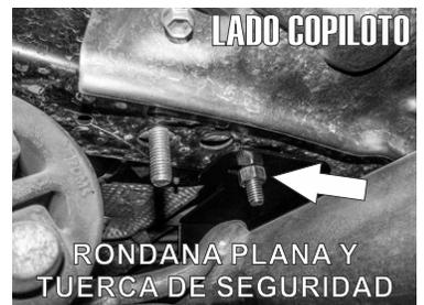
6.- Prensente la pieza de cobre catalizador más larga y fijela al tornillo insertado en el primer paso, usando su respectiva rondana plana y tuerca de seguridad.
