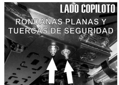
11.- Finalmente presente la pieza corta del protector y fijela al tornillo previamente insertado, usando una rondana plana y tuerca de seguridad de 1/2".
