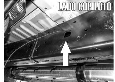
3.- Por la parte lateral del chasis ubique el barreno cuadrado señalado, e inserte otro Tornillo Esp. "T" de 7/16" X 1 1/2", usando una guía de micro alambre para insertarlo y poder sacar la rosca más adelante.
