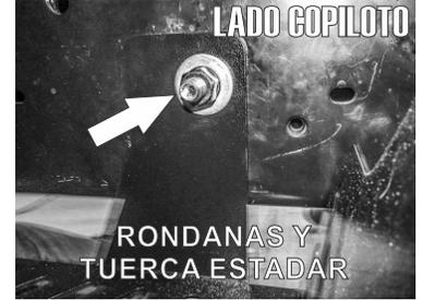
7.- Asegurese de pasar la guía del tornillo insertado en el segundo paso, en el barreno alineado del protector para después sacar el tornillo y fijarlo sando su respectiva rondana plana, rondana de presión y tuerca hexagonal.
