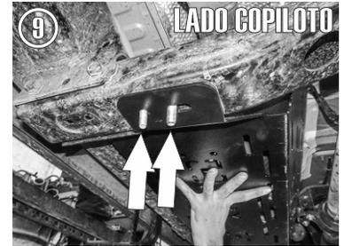
8.- Alinee el siguiente barreno lateral al barreno existente en el chasis y pase de lado a lado un tornillo de 7/16" X 5" con una rondana plana para fijarlo a este.
