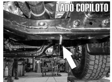
4.- En el siguiente travesaño a la altura del catalizador, ubique los barrenos existentes. Inserte un tornillo Esp. con Varilla de 3/8" X 1 1/4" con ayuda de una guía de micro-alambre pasandolo de la parte superior al barreno más angosto, tal como se ilustra.
