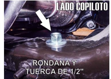
8.- Finalmente para reforzar también la estructura inserte otro tornillo de 1/2" X 3 1/2" con una rondana, ahora de abajo hacia arriba, por el galuz señalado de la pieza y atravesando el chasis. Fije en la parte superior del travesaño con una rondana y una tuerca de seguridad de 1/2.
