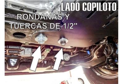
3.- Ahora presente y monte el Protector de lado Piloto a los tornillos previamente insertados al chasis, usando las rondanas y tuercas de seguridad de 1/2" y 7/16" correspondientes a cada tornillo.
