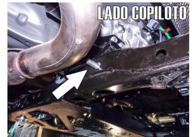
2.- Por el travesaño de soporte posterior señalado en las fotos, inserte un tornillo especial con solera soldada de 7/16" X 1 1/2", metiéndolo por el barreno inferior y sacando la rosca del tornillo por un costado de la estructura.
