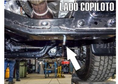
3.- En el siguiente travesaño a la altura del catalizador, ubique los barrenos existentes. Inserte un tornillo Esp. con Varilla de 3/8" X 1 1/4" con ayuda de una guía de micro-alambre pasandolo de la parte superior al barreno más angosto, tal como se ilustra.
