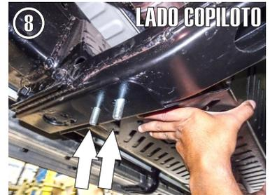
7.- Alinee el siguiente barreno lateral al barreno existente en el chasis y pase de lado a lado un tornillo de 7/16" X 5" con una rondana plana para fijarlo a este.
