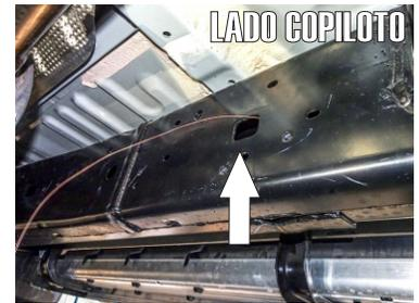
2.- Por la parte lateral del chasis ubique el barreno cuadrado señalado, e inserte otro Tornillo Esp. "T" de 7/16" X 1 1/2", usando una guía de micro alambre para insertarlo y poder sacar la rosca más adelante.
