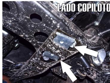
9.- Identifique el travesaño que se encuentra por debajo del motor, e introduzca la solera roscada incluida, alineando ambos barrenos a los resagues del travesaño tal como se señala en las imágenes.
