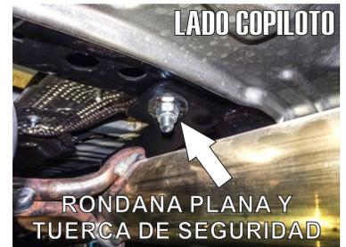
5.- Presente la pieza de cubre catalizador más larga y fijela al tornillo insertado en el primer paso, usando su respectiva rondana plana y tuerca de seguridad.
