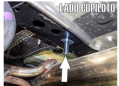
1.- Identifique los barrenos existentes por debajo de la carrocería, en el travesaño del chasis, e introduzca manualmente un Tornillo Esp. "T" de 7/16" X 1 1/2" manualmente en el barreno señalado.
