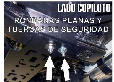
10.- Finalmente presente la pieza corta del protector y fijela a la solera previamente insertada, usando los tornillos de 3/8" X 1" junto con sus rondanas plana y de presión.
