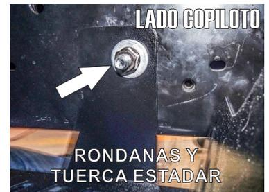
6.- Asegurese de pasar la guía del tornillo insertado en el segundo paso, en el barreno alineado del protector para después sacar el tornillo y fijarlo sando su respectiva rondana plana, rondana de presión y tuerca hexagonal.
