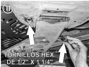
11.- En el barreno contiguo señalado en la imagen inserte igualmente, de manera manual, un tornillo de 1/2" X 1 1/4" junto con una rondana plana, dejando la rosca hacia abajo, tal como se observa, fije con las tuercas y rondanas de 1/2".
