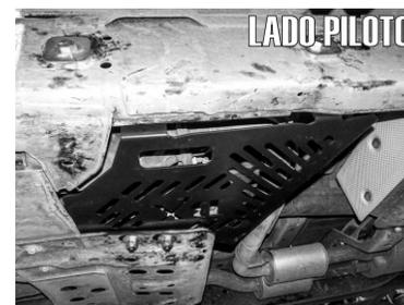
5.- De igual forma, en el barreno a lado de la tolva metálica, deberá insertar otro tornillo de 1/2" X 1 1/4" junto con una rondana plana, ayudándose de una guía de micro alambre dejando la rosca hacia abajo.
