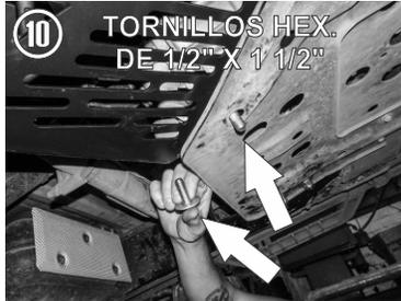
10.- De lado de la tolva metálica deberá insertar de manera manual, dos tornillos de 1/2" X 1 1/2" junto con una rondana plana, dejando la rosca hacia abajo, tal como se observa, fije con las tuercas y rondanas de 1/2".
