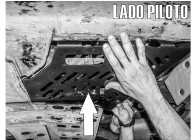
1.- Por debajo del vehículo ubique la posición de los catalizadores. De lado Piloto presente la pieza Protector (Lado Piloto), poniendo una parte sobre la tolva metálica existente, tal como se observa.
