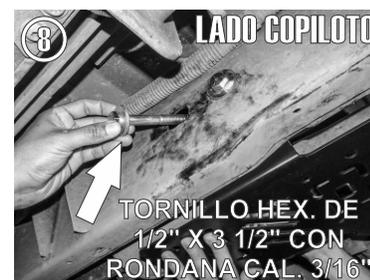
6.- De Lado Copiloto presente la pieza **Protector (Lado Copiloto)** poniendo una parte sobre la tolva metálica existente, tal como se observa.
