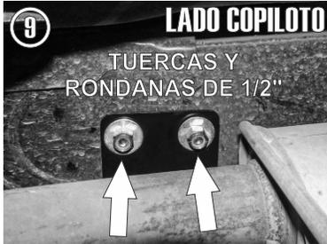
9.- Terminamos fijar el Protector a los tornillos insertados usando las Tuercas y Rondanas de 1/2".
