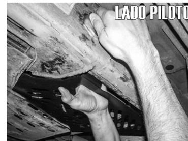
3.- De igual manera en el barreno aledaño por el lado lateral externo del chasis, inserte un tornillo Hexagonal de 1/2" X 4" de lado a lado, usando una Solera cuadrada por la parte externa y la rondana y tuerca de 1/2" del otro lado.
