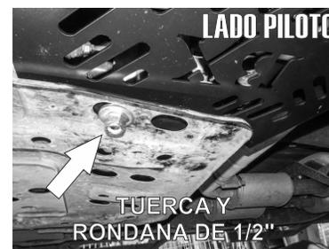
4.- De lado de la tolva metálica deberá insertar un tornillo de 1/2" X 1 1/4" junto con una rondana plana, ayudándose de una guía de micro alambre dejando la rosca hacia abajo, tal como se muestra.
