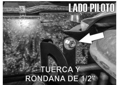
2.- Por el lado lateral externo del chasis, a la altura de la pieza presentada, fije el Protector insertando un tornillo Hexagonal de 1/2" X 3 1/2" de lado a lado, usando una Solera cuadrada por la parte externa y la rondana y tuerca de 1/2" del otro lado.
