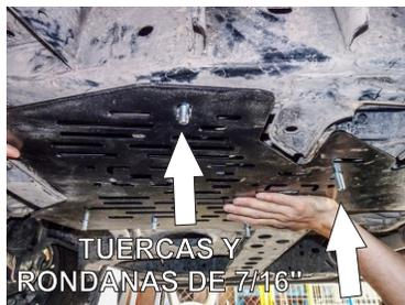
8.- Inserte todos los tornillos a los barrenos correspondientes en el Protector de catalizador, y fijelos a este usando las tuercas de seguridad y rondanas de 7/16" y 3/8" respectivamente. (Use una llave para hacer palanca en el tornillo especial de 7/16")
