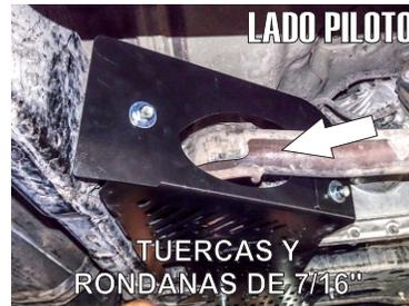
9.- Finalmente presente y fije la placa anexa para una mejor protección. Alineela con los barrenos existentes en las piezas tal como se observa, y use los tornillos de 7/16" X 1" para fijarlas.
