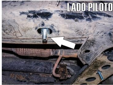
3.- Sobre el chasis, por la parte inferior, también deberá insertar un tornillo especial con solera de 7/16" X 1 1/2", dejando la rosca hacia abajo.
