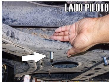
5.- Más hacia el frente del auto, ubique el barreno señalado en las imágenes, por la parte inferior, pase de igual forma, un tornillo de 3/8" X 2 1/2" de arriba a abajo, dejando la rosca hacia abajo.
