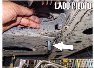
4.- Por debajo, debajo de la flecha del vehículo, identifique el barreno existente marcado y pase un tornillo de 3/8" X 2 1/2" de arriba a abajo, dejando la rosca hacia abajo tal como se muestra.
