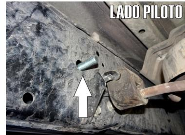
1.- Por debajo del vehículo ubique la posición del catalizador (Lado Piloto). En el Chasis aledeño a este ubique los dos barrenos existentes señalados en las imágenes e inserte un tornillo de 1/2" X 4", dejando la rosca sobre saliendo hacia el catalizador.
