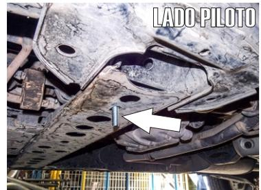
2.- Inserte otro tornillo de 1/2" X 4" en el siguiente barreno existente, dejando la rosca sobre saliendo hacia el catalizador.
