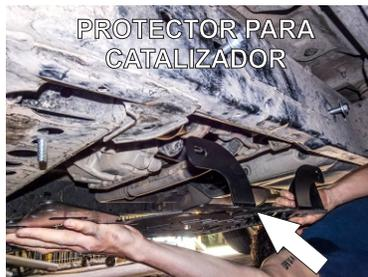
7.- Ya con todos los tornillos puestos, presente y fije el Protector de catalizador, primeramente en los tornillos laterales de 1/2" insertados en los primeros pasos, usando las rondanas y tuercas de seguridad de 1/2".
