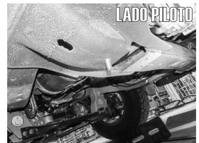
1.- Identifique los barrenos existentes por debajo de la carrocería, en el travesaño del chasis, e introduzca manualmente un Tornillo Esp. "T" con solera y varilla de 7/16" X 1 1/2" manualmente en el barreno señalado.
