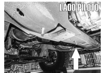
2.- Por la parte superior del travesaño, en el barreno señalado debiera introducir un tornillo hex. de 3/8" X 3" dejando la rosca hacia abajo, tal como se observa.
