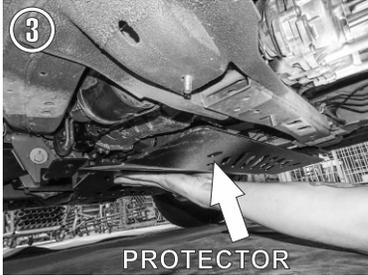
3.- Presente el Protector para catalizador y fíjelo a los tornillos insertados usando sus respectivas rondanas y tuercas de 7/16" y 3/8".
