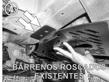
4.- En la parte lateral fije el Protector a la estructura del chasis usando los tornillos hex. de 12mm X 40mm.
