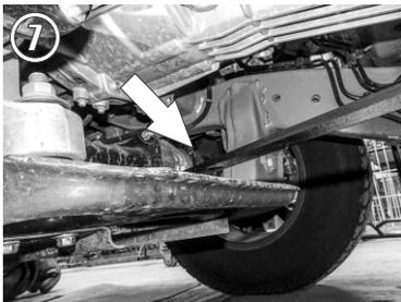
7.- Finalmente fije la pieza al chasis debajo de la transmisión usando una abrazadera de 3/8", fijandola a modo de sandwich con sus rondanas y tuercas de 3/8". Apriete todos los tornillos.
