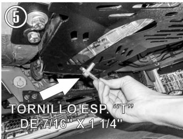
5.- Ahora deberá pasar un Tornillo Esp. "T" de 7/16" X 1 1/4" manualmente por encima del protector y sacando la rosca hacia abajo en el barreno existente.
