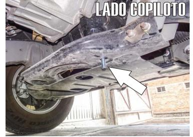
2.- Hacia la parte frontal en el soporte debajo de la transmisión del auto deberá pasar de arriba hacia abajo un tornillo de 1/2" X 2" en el barreno marcado en las imágenes.
