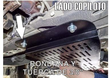
4.- Presente el Protector para catalizador y fíjelo a los tornillos insertados usando sus respectivas rondanas y tuercas de 7/16" y 3/8".
