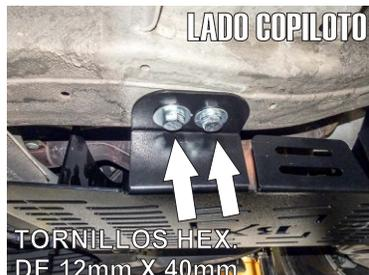
7.- Finalmente en la parte lateral fije el Protector a la estructura del chasis usando los tornillos hex. de 12mm X 40mm. Apriete al final todos los tornillos.
