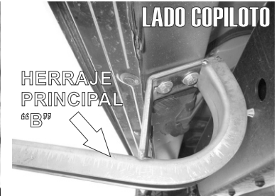
TORNILLOS CAB HEX. DE 8 mm X 30 mm
