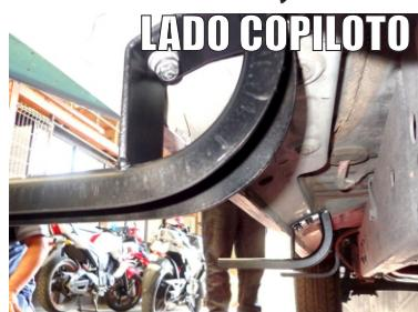
2.- Presente el Herraje Frontal "A" en los barrenos frontales del vehículo y fijelo con los Tornillos de 8mm X 30mm. De igual manera fije los Herrajes Intermedios y Posteriores "B" en los barrenos intermedios y posteriores de vehículo.
