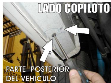
1.- Identifique los tornillos plásticos por debajo de la carrocería de su vehículo y proceda a retirarlos con un desarmador plano, para dejar los barrenos roscados al descubiertos.
