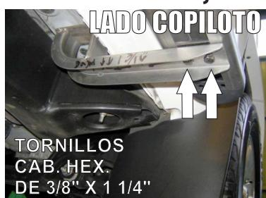
3.- Presente el estríbo sobre los herrajes e introduzca el Herraje Auxiliar "C" por dentro del estríbo y deslicelo manualmente hasta que coincida con los barrenos de los Herrajes Principales "A" y "B", enseguida fije los herrajes en manera de sandwich utilizando los tornillos de 3/8" X 1 1/4".
