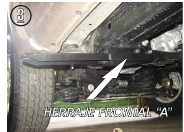
3.- Presente el Herraje Principal "A" en los tornillos existentes y fíjelo con las rondanas y tuercas de 3/8" y con las tuercas que retiro con anterioridad.
