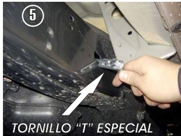
5.- Inserte un tornillo "T" especial en el resaque ovalado del Chasis con la punta del tornillo hacia fuera, como indica la fotografía. (Nota: Evite que caiga el tornillo dentro del chasis)
