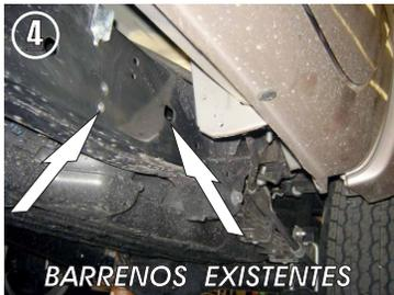
4.- Identifique los resaque y los barrenos roscados, en la parte posterior del chasis.
