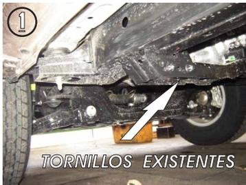
1.- Identifique los barrenos y tornillos existentes en el soporte transversal, por debajo del chasis.
