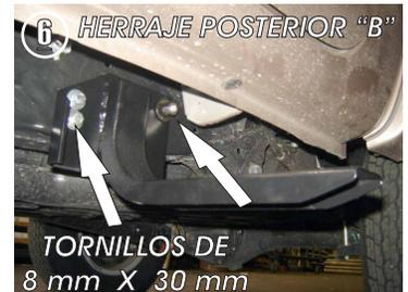
6.- Inserte con cuidado el Herraje Posterior "B" en el tornillo que inserto con anterioridad y fijelo con las rondanas y tuerca de 7/16". Enseguida fije el herraje en los barrenos roscados del chasis con los tornillos de 8 mm X 30 mm.
