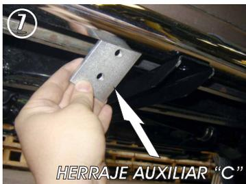
7.- Presente el estribo sobre los herrajes Principales e introduzca los **Herrajes Auxiliares "C"** por dentro del estribo y deslicelos manualmente hasta que coincidan con los barrenos de los **Herrajes Principales "A" y "B"**, enseguida fije los herrajes en manera de sandwich utilizando los tornillos de 3/8" X 1".
