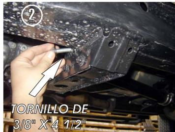
2.- Inserte un tornillo de 3/8" X 4 1/2" en el barreno superior y retire las tuercas de los tornillos existentes, del puente transversal.
