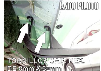
2.- Identifique y presente el **Herraje Intermedio "B"** en dirección de los barrenos roscados existentes y fíjelo firmemente con los Tornillos Cab. Hex. de 8mm X 30mm.
