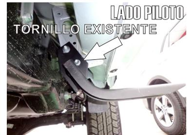
3.- Identifique y presente el **Herraje Posteriores "C"** en dirección al barreno y tornillo existentes y fíjelo firmemente con la Tuerca de 8mm y el Tornillo Cab. Hex. de 8mm X 30mm.
