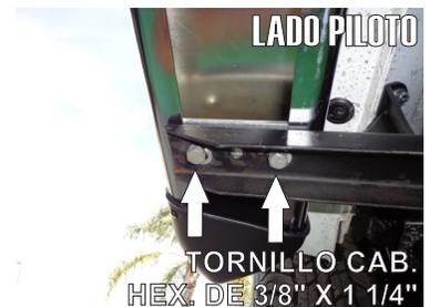
4.- Una vez que se han instalado los Herrajes anteriores presente el estribo del Lado Piloto e inserte el **Herraje Auxiliar "D"** por la parte posterior colocandolos en coincidencia de cada herraje y fijandolos con los Tornillos de 3/8" x 1 1/4" y Rondanas de 3/8".
