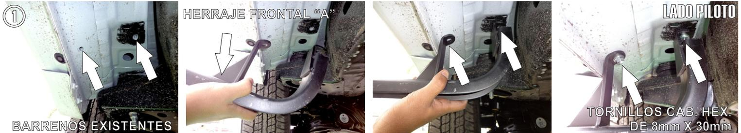
1.- Identifique y presente el **Herraje Frontal "A"** en dirección de los barrenos roscados existentes y fijelo firmemente con los Tornillos Cab. Hex. de 8mm X 30mm.
