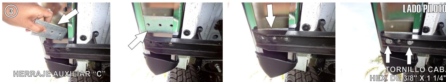
3.- Una vez que se han instalado los Herrajes anteriores presente el estribo del Lado Piloto e inserte el **Herraje Auxiliar "C"** por la parte posterior colocandolos en coincidencia de cada herraje y fijandolos con los Tornillos de 3/8" x 1 1/4" y Rondanas de 3/8".
