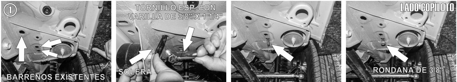
1.- Por el costado, debajo de la carrocería, identifique los barrenos existentes señalados en la primer imagen y proceda a introducir un tornillo esp. con varilla de 3/8" X 1 1/4" y una solera con barrenos en el barreno mas amplio, ayudandose de una guía de micro-alambre, de tal forma que el tornillo atraviese la solera y la rosca sobre salga por la parte inferior, retire la guía y pongale una tuerca para que no se vaya a meter el tornillo por accidente.
