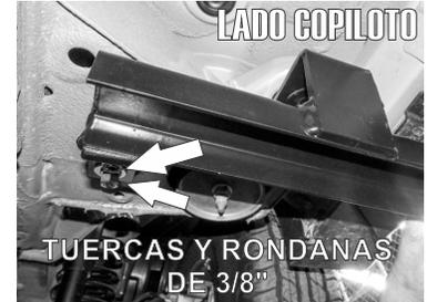
1.- Vuelva a meter otro tornillo esp. con varilla de 3/8" X 1 1/4" en el otro barreno, este también deberá pasar a través del barreno existente de la solera introducida y dejando la rosca sobresaliendo hacia abajo. Ayudese de igual manera de la guía de micro-alambre tal como se muestra.
