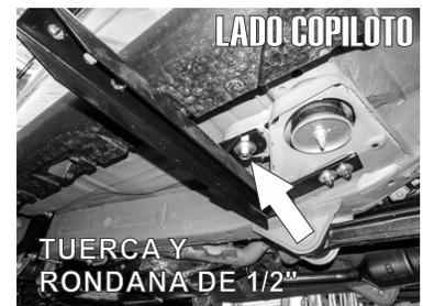
1.- Termine de fijar el Herraje usando un tornillo de 1/2" X 1 1/2" para la parte superior junto con una solera redonda a modo de rondana, agarrándose de la oreja en el chasis que se observa en las imágenes.
