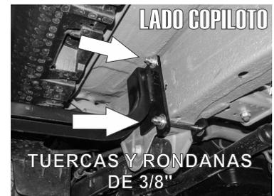
1.- Para instalar el **Herraje Trasero "B"**, deberá pasar por detrás del chasis el **Herraje Auxiliar "C"** para tomarlo de agarre pasando los tornillos de 3/8" X 4", tanto arriba como abajo y fije a modo de sandwich con la estructura.
