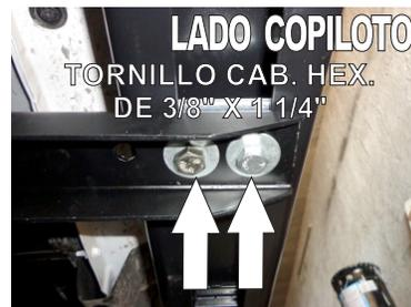
6.- Una vez que se han instalado los Herrajes anteriores presente el estribo del Lado Piloto e inserte el **Herraje Auxiliar "C"** por la parte posterior colocandolos en coincidencia de cada herraje y fijandolos con los Tornillos de 3/8" x 1 1/4" y Rondanas de 3/8".
