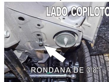
1.- Por el costado, debajo de la carrocería, identifique los barrenos existentes señalados en la primer imagen y proceda a introducir un tornillo esp. con varilla de 3/8" X 1 1/4" y una solera con barrenos en el barreno mas amplio, ayudandose de una guía de micro-alambre, de tal forma que el tornillo atravesase la solera y la rosca sobre salga por la parte inferior, retire la guía y pongale una tuerca para que no se vaya a meter el tornillo por accidente.
