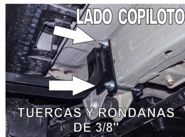
5.- Para instalar el **Herraje Trasero "B"**, deberá pasar por detrás del chasis el **Herraje Auxiliar "C"** para tomarlo de agarre pasando los tornillos de 3/8" X 4", tanto arriba como abajo y fije a modo de sandwich con la estructura.
