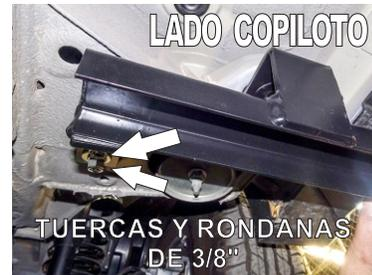
2.- Vuelva a meter otro tornillo esp. con varilla de 3/8" X 1 1/4" en el otro barreno, este también deberá pasar a través del barreno existente de la solera introducida y dejando la rosca sobresaliendo hacia abajo. Ayudese de igual manera de la guía de micro-alambre tal como se muestra.
