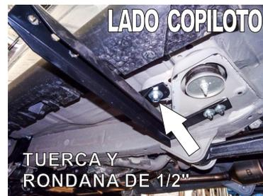
4.- Termine de fijar el Herraje usando un tornillo de 1/2" X 1 1/2" para la parte superior junto con una solera redonda a modo de rondana, agarrándose de la oreja en el chasis que se observa en las imágenes.
