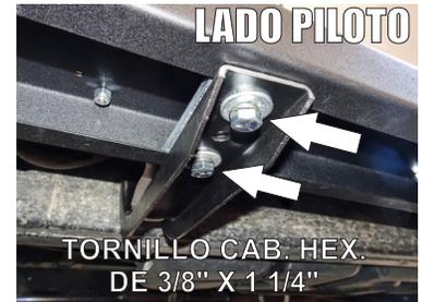
3.- Presente el estribo sobre los herrajes e introduzca el **Herraje Auxiliar "C"** por dentro del estribo y deslicelo manualmente hasta que coincida con los barrenos de los **Herrajes "A" y "B"**, enseguida fije los herrajes en manera de sandwich utilizando los tornillos de 3/8" X 1 1/4" junto con sus respectivas rondanas plana y de presión.
