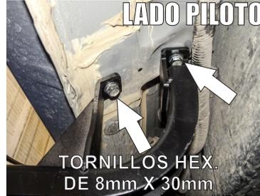
2.- Por la parte trasera Identifique los barrenos existentes. Presente el **Herraje Posterior "B"** y fíjelo con los Tornillo Cab.Hex. de 8mm X 30mm junto con sus respectivas rondanas plana y de presión de 5/16".
