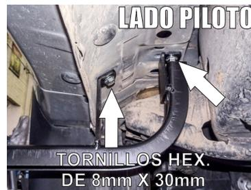
1.- Identifique los barrenos existentes por debajo de la carrocería.
