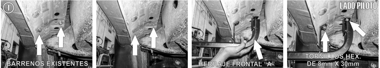
1.- Identifique los tornillos existentes por debajo de la carrocería, en la parte frontal lateral y proceda a retirarlos. Presente el **Herraje Frontal "A"** y fíjelo a los barrenos con los tornillos de 8mm X 30mm junto con sus respectivas rondanas plana y de presión.
