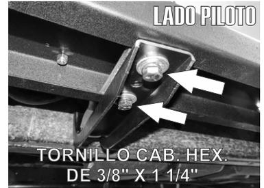
4.- Presente el estribo sobre los herrajes e introduzca el **Herraje Auxiliar "C"** por dentro del estribo y deslicelo manualmente hasta que coincida con los barrenos de los **Herrajes "A" y "B"**, enseguida fije los herrajes en manera de sandwich utilizando los tornillos de 3/8" X 1 1/4" junto con sus respectivas rondanas plana y de presión.
