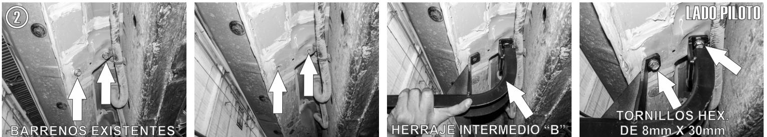
2.- Igualmente ubique los tornillos existentes por debajo de la carrocería, por la parte media y proceda a retirarlos. Presente el **Herraje Intermedio "B"** y fíjelo a los barrenos con los tornillos de 8mm X 30mm junto con sus respectivas rondanas plana y de presión.
