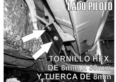
3.- Por la parte trasera Identifique la estructura transversal y proceda a retirar la tuerca y el tornillo existentes. Presente el **Herraje Trasero "B"** y fíjelo al tornillo con una tuerca de 8mm y un tornillo de 8mm X 30mm junto con sus respectivas rondanas plana y de presión.
