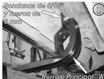
2.- Presente los **Herrajes Principales "A"** en los tornillos existentes y fijelos con las rondanas de 5/16" y las tuercas de 8 mm.
