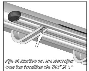
Nivele y centre el estribo y apriete hasta el final todos los tornillos, empezando por los herrajes que se fijan con la carrocería, para lograr una correcta instalación.
