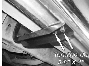
4.- Presente el estribo sobre los Herrajes Principales e introduzca los **Herrajes Auxiliares "B"** por dentro del estribo y deslicelos manualmente hasta que coincidan con los barrenos de los **Herrajes Principales "A"**. Enseguida fije los herrajes en manera de sandwich con los tornillos de 3/8" X 1". Nivele y centre el estribo y apriete hasta el final todos los tornillos empezando por los herrajes que se fijan con la carrocería, para lograr una correcta instalación.
