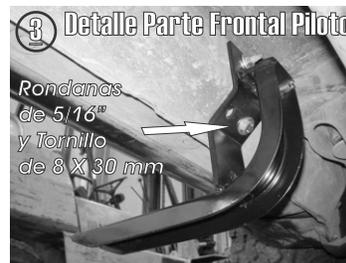
3.- Enseguida fije los herrajes por la parte inferior, en el barreno existente con las rondanas de 5/16" y el tornillo de 8 mm X 30 mm.
