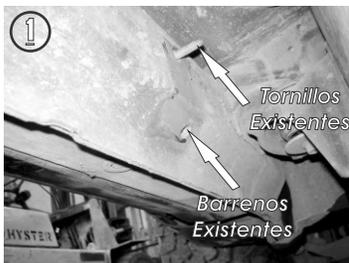
1.- Identifique los barrenos y tornillos existentes por debajo de la carrocería de su vehículo.
