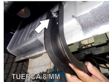
5.- Coloque el Herraje Posterior Largo "C" sobre la rosca del tornillo existente acompañado de Ronda Plana, de Presión 5/16" y finalice colocando la Tuerca Hex. de 8mm.
