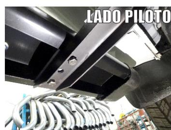
9.- Enseguida fije los herrajes en manera de sandwich utilizando los tornillos de 3/8" X 1 1/4", Rondana Plana y de Presión de 3/8". Nivele y centre el estribo y apriete hasta el final todos los tornillos empezando por los herrajes que se fijan con la carrocería, para lograr una correcta instalación.
