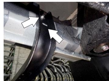
2.- Coloque el Herraje Frontal Corto "A" sobre la rosca del tornillo existente acompañado de Ronda Plana, de Presión 5/16" y finalice colocando la Tuerca Hex. de 8mm.
