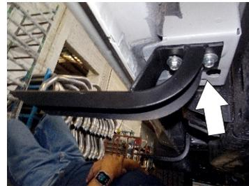
4.- Ahora presente el Herraje Central "B". Posicione sobre los Barrenos Existentes y proceda a fijarlos con Tornillo de 8mm X 25 mm, rondana Plana, de Presión 5/16" como se muestra en las imágenes y repita el mismo procedimiento en el Lado Copiloto.
