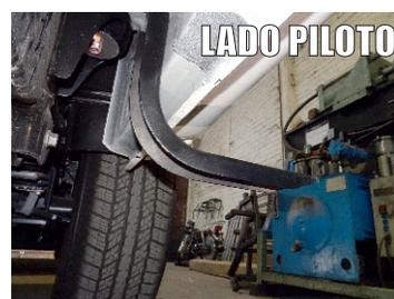
6.- Proceda a colocar en el Barreno Existente el Tornillo de 8mm X 25 mm, Rondana Plana, de Presión 5/16" y fije.
