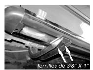
9.- Presente el estribo sobre los herrajes e introduzca el **Herraje Auxiliar** "D" por dentro del estribo y deslicelo manualmente hasta que coincida con los barrenos de los **Herrajes Principales**, enseguida fije los herrajes en manera de sandwich utilizando los tornillos de 3/8" X 1".
