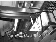
7.- Presente el estribo sobre los herrajes e introduzca el Herraje Auxiliar "B" por dentro del estribo y deslicelo manualmente hasta que coincida con los barrenos de los Herraje Principales "A", ensequida fije los herrajes en manera de sandwich utilizando los tornillos de 3/8" X 1". Nivele y centre el estribo y apriete hasta el final todos los tornillos empezando por los herrajes que se fijan con la carrocería, para garantizar una correcta instalación.
