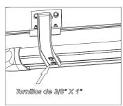
5.- Presente el estribo sobre los Herrajes Principales e introduzca los Herrajes Auxillares "B" por dentro del estribo y deslicelos manualmente hasta que coincidan con los barrenos de los Herrajes Principales "A", ensequida file los herrajes en manera de sandwich utilizando los tornillos de 3/8" X 1".
