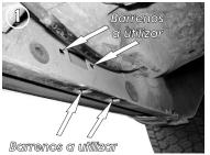
**1.-** Identifique los barrenos existentes por debajo del la carrocería de su vehiculo.
