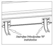
3.- Presente el Herraje Principal "A" en los barrenos existentes y fijelo en las grapas especiales con los tornillos de 5/16" X 1".
