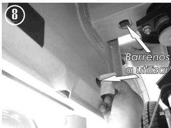
8.- Identifique por debajo del vehículo los barrenos ubicados sobre la carrocería.
