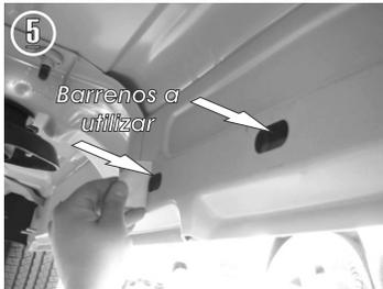
5.- Identifique por debajo del vehículo los barrenos ubicados sobre la carrocería.
