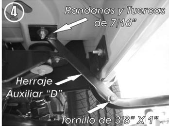
4.- Presente el **Herraje Auxiliar "D"** en el tornillo superior que inserto y fijelo con las rondanas y tuercas de 7/16" y al otro extremo fijelo en el barreno del **Herraje Frontal "A"** con el tornillo de 3/8" X 1".
