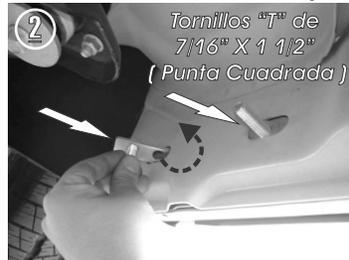
2.- Inserte en modo de giro los tornillos "T" de 7/16" X 1 1/2" ( Tornillo soldado hacia la punta Cuadrada ), dentro de los barrenos de la carrocería y en la parte superior inserte también en modo de giro un tornillo "T" de 7/16" X 1 1/2" ( Tornillo soldado hacia la punta Redonda ).
