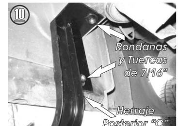
10.- Fije el **Herraje Posterior "C"** en el tornillo superior y en el tornillo lateral con las rondanas y tuercas de 7/16".
