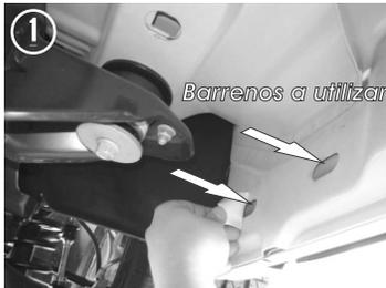
1.- Identifique por debajo del vehículo los barrenos ubicados sobre la carrocería.
