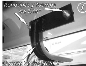
7.- Enseguida fije el **Herraje Intermedio "B"** en los tornillos laterales que inserto con las rondanas y tuercas de 7/16"
