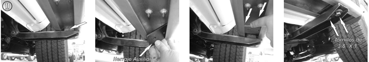
11.- Presente el estribo sobre los herrajes e introduzca el **Herraje Auxiliar "E"** por dentro del estribo y deslicelo manualmente hasta que coincida con los barrenos de los **Herrajes Principales "A", "B" y "C"**, enseguida fije los herrajes en manera de sandwich utilizando los tornillos de 3/8" X 1".
