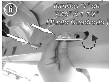
6.- Inserte en modo de giro los tornillos "T" de 7/16" X 1 1/2" ( **Tornillo soldado hacia la punta Cuadrada** ), dentro de los barrenos de la carrocería.
