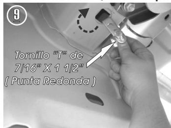
9.- Presente el tornillo "T" de 7/16" X 1 1/2" ( **Tornillo soldado hacia la punta Redonda** ), en el barreno superior e insertelo en modo de giro y en el barreno lateral de la carrocería inserte en modo de giro un tornillo "T" de 7/16" X 1 1/2" ( **Tornillo soldado hacia la punta Cuadrada** ).
