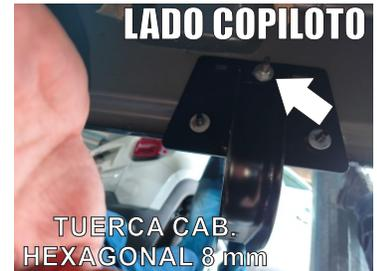
4.- Ahora coloque el Herraje Principal "A" en los siguientes tornillos existentes como se muestra en las imágenes y vuelva afijarlos con sus respectivas Rondana Plana, de Presión 5/16" y su Tuerca Cab. Hexagonal de 8 mm.
