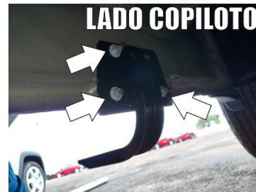
5.- Para finalizar con los Herrajes Principales "A", coloque este último en los barrenos posteriores como se muestra en las imágenes y coloque los tornillos faltantes Rondana Plana, de Presión 5/16" y Tuerca Cab. Hexagonal de 8 mm.
