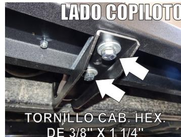
7.- Presente el estribo sobre los herrajes e introduzca el **Herraje Auxiliar "B"** por dentro del estribo y deslicelo manualmente hasta que coincida con los barrenos de los **Herrajes Principal "A"**, enseguida fije los herrajes en manera de sandwich utilizando los tornillos de 3/8" X 1 1/4" junto con sus respectivas rondanas plana y de presión.3/8"
