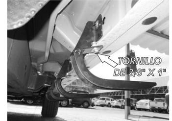
5.- Identifique los barrenos existentes por debajo de la carrocería del vehículo ( en dirección de la manija de la puerta posterior ) y retire con un desarmador plano el tapón de plástico e inserte la grapa de lamina del barreno grande hacia el pequeño sobre el costado de la carrocería.
