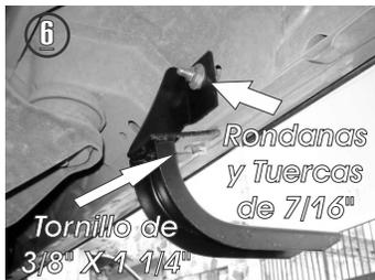
6.- Presente el **Herraje Principal "A"** en el tornillo que inserto y fijelo con las rondanas y tuerca de 7/16". Enseguida fije el herraje con el barreno inferior de la carrocería utilizando el tornillo de 3/8" X 1 1/4".
