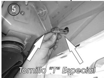
5.- Rosque la guía de micro-alambre con el tornillo "T" e inserte el Tornillo manualmente en el barreno grande. Enseguida meta la punta de la guía del barreno grande hacia el pequeño y jale la guía hasta sacar la punta del tornillo por dicho barreno. Una vez insertado el tornillo, desenrosque la guía cuidadosamente, evitando que el tornillo caiga dentro de la carrocería ó si prefiere coloque el **Herraje Principal "A"** y con el mismo, trabe el tornillo y desenrosque la guía de micro-alambre.
