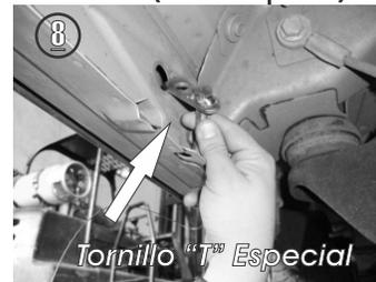
8.- Rosque la guía de micro-alambre con el tornillo "T" e inserte el Tornillo manualmente en el barreno grande. Enseguida meta la punta de la guía del barreno grande hacia el pequeño y jale la guía hasta sacar la punta del tornillo por dicho barreno. Una vez insertado el tornillo, desenrosque la guía cuidadosamente, evitando que el tornillo caiga dentro de la carrocería ó si prefiere coloque el **Herraje Principal "A"** y con el mismo, trabe el tornillo y desenrosque la guía de micro-alambre.
