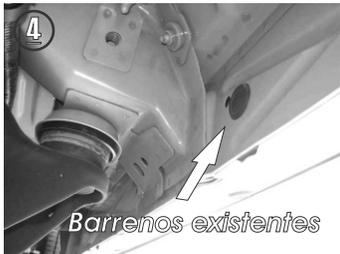
4.- Identifique los barrenos cerca del soporte intermedio de la carrocería y en caso de traer tapones de plástico, proceda a retirarlos manualmente.
