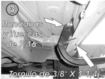
3.- Presente el **Herraje Principal "A"** en el tornillo que inserto y fijelo con las rondanas y tuerca de 7/16". Enseguida fije el herraje con el barreno inferior de la carrocería utilizando el tornillo de 3/8" X 1 1/4".
