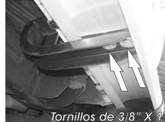
**10.-** Presente el estribo sobre los Herrajes Principales e introduzca los **Herrajes Auxiliares "B"** por dentro del estribo y deslicelos manualmente hasta que coincidan con los barrenos de los **Herrajes Principales "A"**. Enseguida fije el estribo en manera de sandwich utilizando los tornillos de 3/8" X 1".
