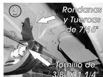
9.- Presente el **Herraje Principal "A"** en el tornillo que inserto y fijelo con las rondanas y tuerca de 7/16". Enseguida fije el herraje con el barreno inferior de la carrocería utilizando el tornillo de 3/8" X 1 1/4".
