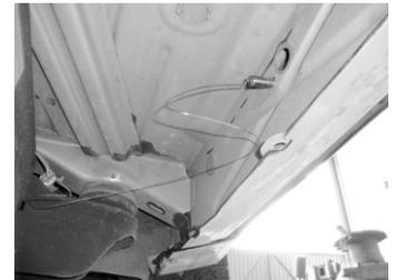
1.- Identifique los dos barrenos en la parte frontal de la carrocería y en caso de traer tapones de plástico, proceda a retirarlos manualmente.
