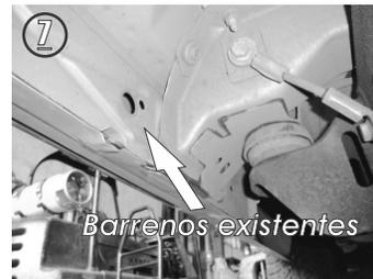
7.- Identifique los dos barrenos en la parte posterior de la carrocería y en caso de traer tapones de plástico, proceda a retirarlos manualmente.
