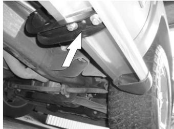
**11.-** Nivele y centre el estribo y apriete hasta el final todos los tornillos empezando por los herrajes para lograr una correcta instalación.
