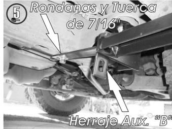
5.- Presente el **Herraje Auxiliar "B"** en el tornillo que inserto y fijelo con las rondanas y tuerca de 7/16". Después fije el otro extremo con el **Herraje Frontal "A"** utilizando el tornillo de 1/2" X 1 1/2".
