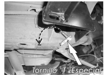
1.- Localice por debajo del vehículo el Soporte Delantero que une el chasis con la carrocería y proceda a retirar el tornillo y el empaque de hule con el dado de 18 mm.
