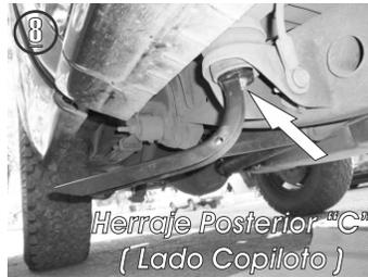
8.- Coloque el **Herraje Posterior "C"** junto con el empaque de hule y apriete levemente el herraje con el tornillo existente.
