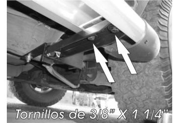
11.- Presente el estribo sobre los herrajes e introduzca los **Herrajes Auxiliares "E"** por dentro del estribo y deslicelos manualmente hasta que coincidan con los barrenos de los **Herrajes Frontales "A" y Posteriores "C"**, enseguida fije los herrajes en manera de sandwich utilizando los tornillos de 3/8" X 1 1/4".
