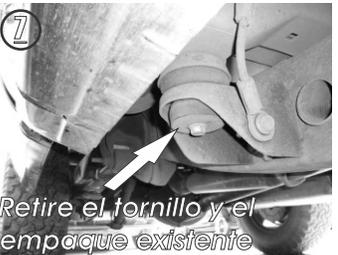
7.- Localice por debajo del vehículo el **Soporte Posterior** que une el chasis con la carrocería y proceda a retirar el tornillo y el empaque de hule con el dado de 18 mm.
