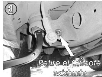
9.- Identifique el chicote que se fija con el soporte del chasis y proceda a retirarlo quitando el tornillo con el dado 3/4". Enseguida presente el **Herraje Auxiliar "D"** en el barreno del soporte y fijelo con el chicote y el tornillo existente.
