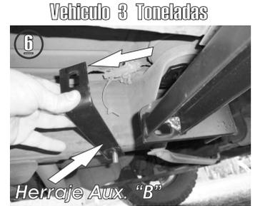
6.- Para el vehículo 3 Ton. tendrá que colocar el **Herraje Auxiliar "B"** con el doblez hacia arriba.
