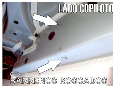
TORNILLO DE 8mm X 30mm
