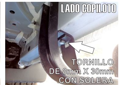
TORNILLO DE 8mm X 30mm
