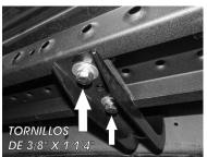
4.- Presente el estribo sobre los herrajes principales e introduzca los Herrajes Auxiliares "B" por dentro del estribo y deslicelos manualmente hasta que coincidan con los barrenos de los Herrajes Principales "A", enseguida fije los herrajes en manera de sandwich utilizando los tornillos de 3/8" X 1 1/4".
