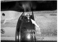
2.- Identifique el Tornillo existente por debajo de la carrocería del vehículo, ( en dirección de la manija de la puerta delantera) y descubra la tuerca existente, quitando la cinta plástica en la parte inferior. Presente el Herraje Principal "A" en el tornillo superior y fijelo con la tuerca de 8mm y las rondanas de 5/16" y en la parte inferior fije el Herraje con el tornillo de 8 X 30mm y las rondanas de 5/16".
