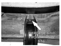
1.- Identifique el Tornillo existente por debajo de la carrocería del vehículo, ( en dirección del espejo de la puerta delantera ) y descubra la tuerca existente, quitando la cinta plástica en la parte inferior. Presente el Herraje Principal "A" en el tornillo superior y fijelo con la tuerca de 8mm y las rondanas de 5/16" y en la parte inferior fije el Herraje con el tornillo de 8 X 30mm y las rondanas de 5/16".
