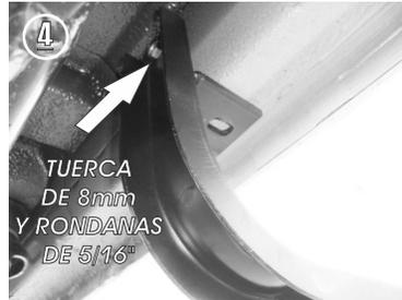
4.- Presente el Herraje Principal "A" en el tornillo superior y fíjelo con la tuerca de 8mm y las rondanas de 5/16" y en la parte inferior fije el Herraje con el tornillo de 8 X 30mm y las rondanas de 5/16".
