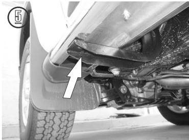
5.- Presente el estribo sobre los herrajes principales e introduzca los Herrajes Auxiliares "B" por dentro del estribo y deslicelos manualmente hasta que coincidan con los barrenos de los Herrajes Principales "A", enseguida fije los herrajes en manera de sandwich utilizando los tornillos de 3/8" X 1 1/4".
