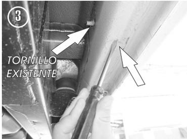
3.- Identifique el Tornillo existente por debajo de la carrocería del vehículo, ( en dirección de la manija de la puerta delantera ) y descubra la tuerca existente, quitando la cinta plástica en la parte inferior de la carrocería, ayudado con un desarmador plano.
